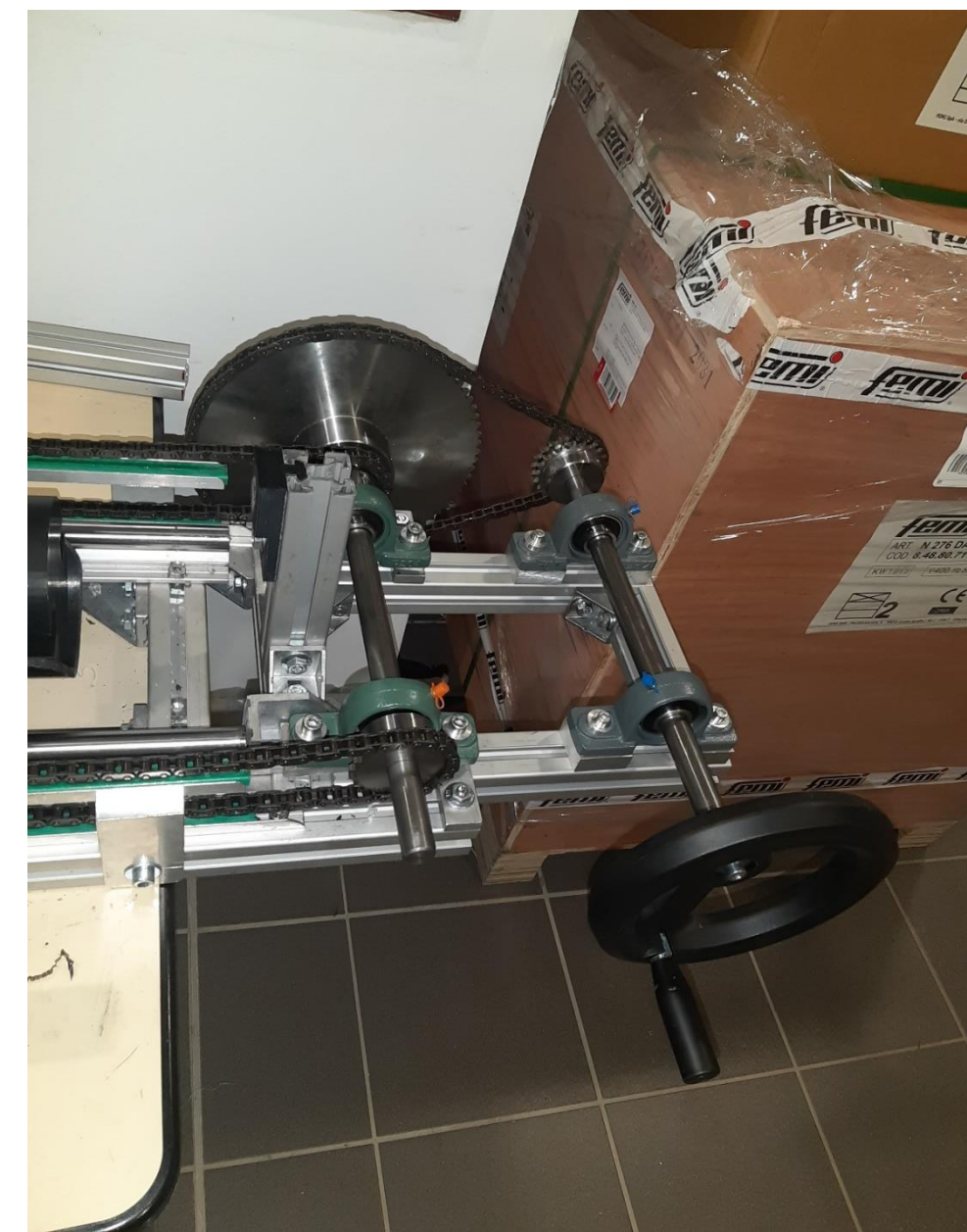
Système d'entraînement par chaîne du berceau porte outils
